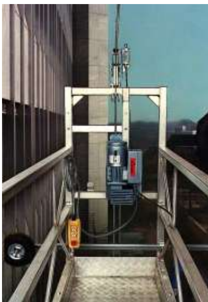
Wciągarka TIRAK jest standardowym wyposażeniem platform ALTA
