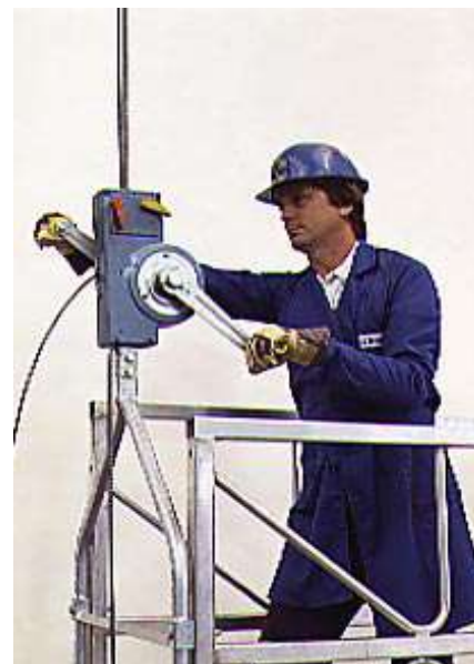
Ręczna wciągarka SCAFOR stosowana do lekkich platform
